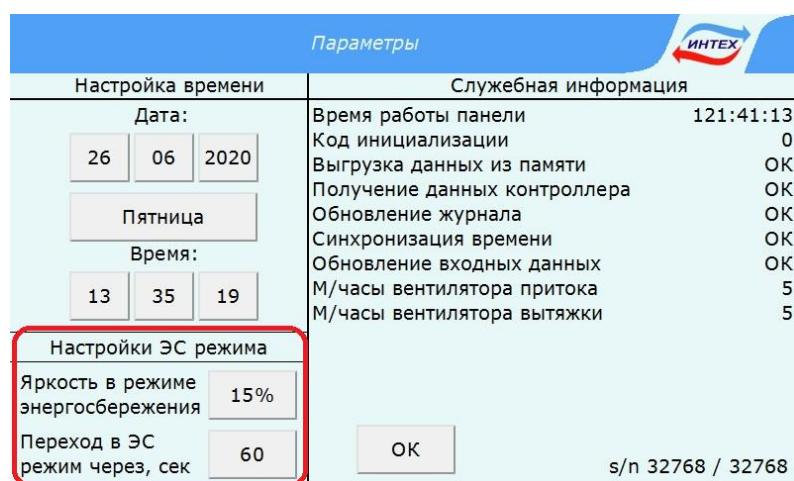
Кнопка «Яркость в режиме энергосбережения» позволяет выбрать подходящее значение яркости экрана в режиме ЭС. При нажатии на кнопку отобразится цифровая клавиатура с предложением ввести новое значение яркости экрана в режиме ЭС. Допустимый диапазон 0-100%, при этом значения в диапазоне 0..9% будут восприниматься как 0%.
