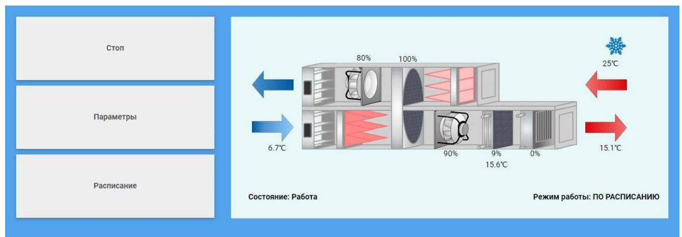
Реализованная система диспетчеризации позволяет запускать и останавливать агрегат, задавать уставки температуры, производительности вентиляторов и т.д., устанавливать время года, следить за текущими показателями агрегата, а также настраивать его расписание работы.
