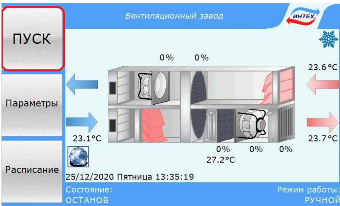
Агрегат переходит в режим «Прогрев» при этом кран обвязки калорифера открывается до достижения температурой обратной воды значения +50°C. В режиме «Прогрев» агрегат может находиться сколько угодно долго, пока температура обратной воды не достигнет +50°C.
