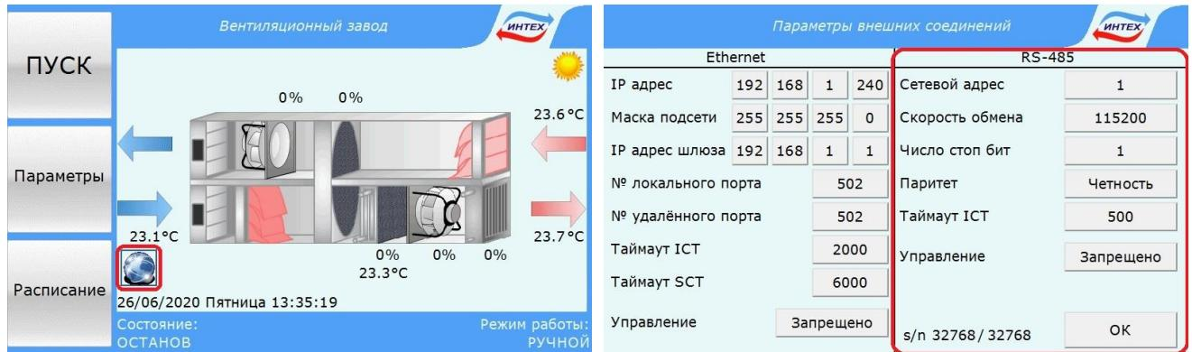
Запись нового значения параметра происходит при получении нового значения в регистр записи панели оператора (при условии соответствия нового значения допустимому диапазону).
