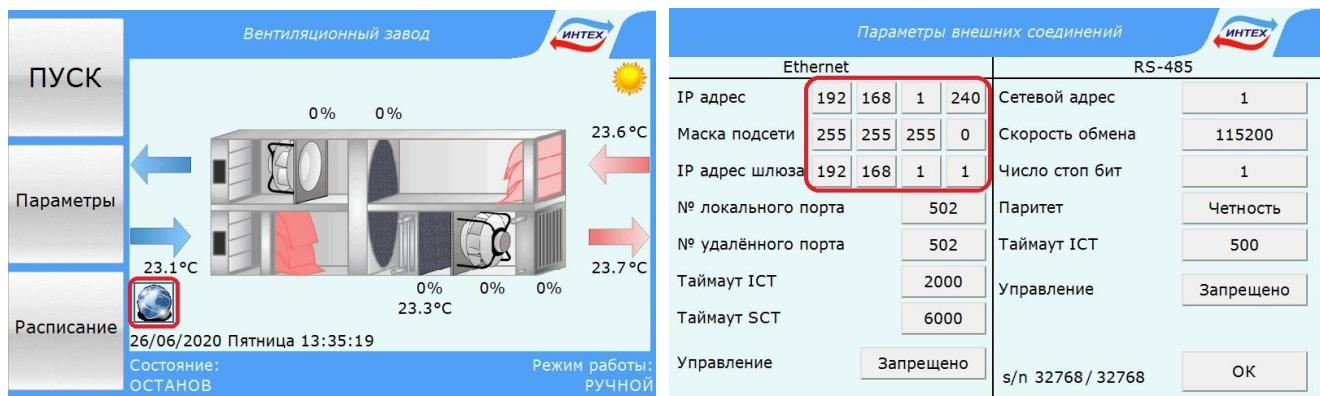
5. Задать соответствующие локальной сети настройки параметров: «IP адрес», «Маска подсети» и «IP адрес шлюза». Указанные настройки Вы можете уточнить у системного администратора, отвечающего за локальную сеть, к которой подключен агрегат.
